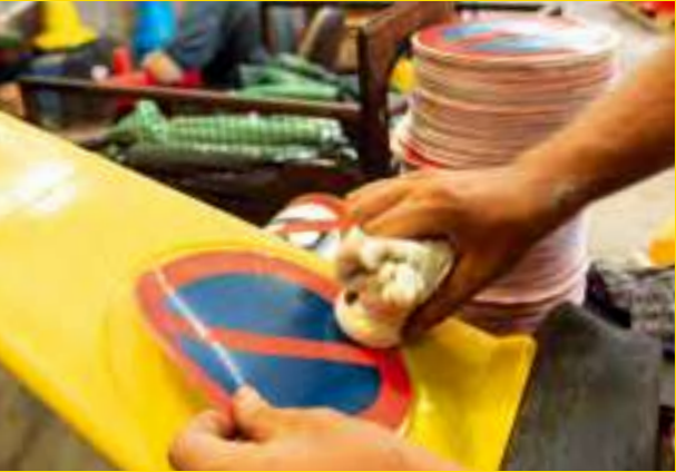
Світловідбиваючий диск акуратно наноситься на новий конус МК™ 4 для заборони стоянки.
